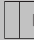
SCHIEBETÜR MIT EINEM FESTEN SEITENTEIL SLIDING DOOR WITH ONE FIXED SIDE SECTION
